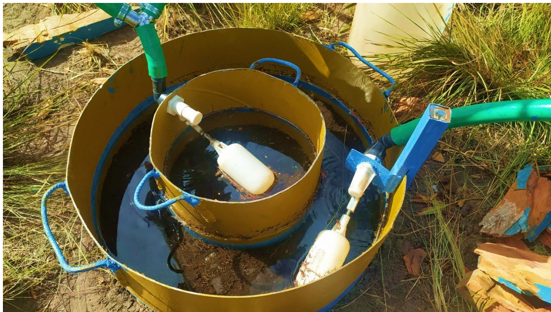
Figura 10 – Anéis de infiltração: Encaixe dos registros do tipo bóia. Fonte: Autores.
