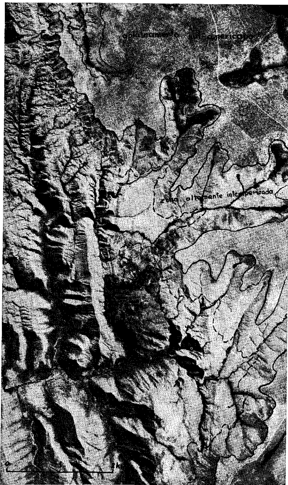
PAR Estereoscópico n.º 3 — Mesma localidade do par anterior. Aqui se vê o bordo do planalto sul-americano sendo dissecado pela erosão atual. Assinalado com a linha interrompida pode-se observar a profunda zona intemperizada, com cerca de trinta metros de espessura, resultante da longa exposição da superfície Sul-Americana ao intemperismo químico. Esta camada de solo apresenta-se com um aspecto homogêneo, aparentemente discordante com as rochas do substrato e um relevo ravinado simulando rochas argilosas. Este fato é causa de constantes equívocos, tanto em superficiais observações de campo como em foto-interpretação. Este manto intemperizado desenvolvendo-se sobre camadas sub-horizontais, arcólio-sílticas, da formação Três Marias (grupo Bambuí), foi confundida muitas vezes com sedimentos mesozóicos. Quando se desenvolve sobre gnaisses é facilmente confundida com xistos. Estes enganos são mais frequentes quando a capa detritica superficial já foi removida. (Aerofoto PROSPEC S.A.).
