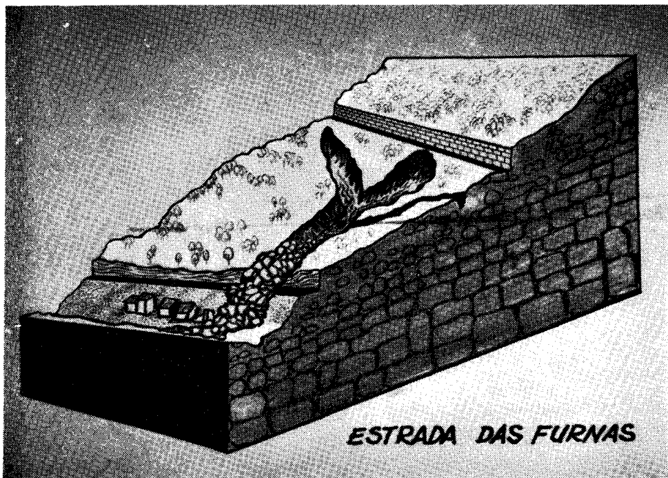
Fig. 4 — Diagrama esquemático mostrando as características geológicas e geomorfológicas apresentadas pela encosta atingida. O movimento de massa de 1966 deu origem a dois canais bem marcados na topografia. Os detritos do deslizamento acumularam-se no fundo do vale do rio das Cachoeiras.
