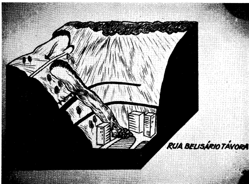
Fig. 9 — Diagrama esquemático mostrando as características geomorfológicas da encosta atingida pelo movimento de massa de fevereiro de 1967.
