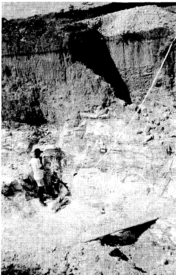
Foto 16 - Garimpeiros trabalham com picareta no veio. O serviço foi rebaixado com bico-jato. Observar a profundidade da cat no Garimpo do Tartarugalzinho (abr 1994)
