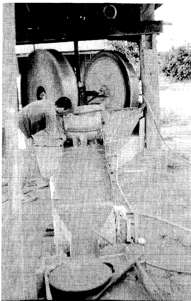
Foto 8 - Caixa que contém bica canadense riffada para concentração do ouro. Ve-se o momento em que se faz a repescagem, isto é, a recuperação do ouro, em Matupá (out 1993)
