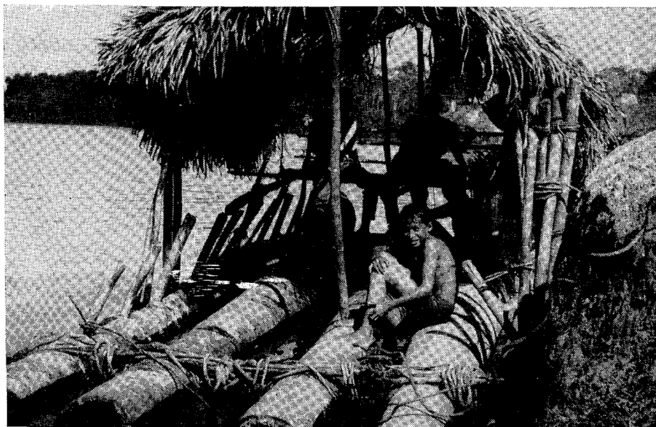
Fig. 33 — Tipo de balsa rústica coberta de jarina para descer os rios amazônicos peruanos conduzindo carga variada
