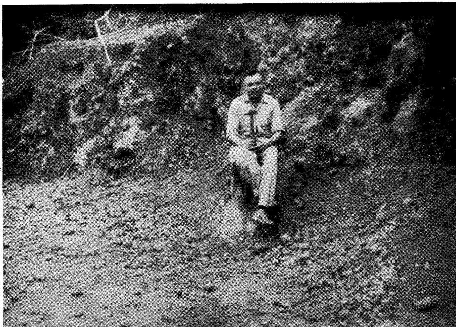
Fig. 8 — Cascalheira do quilômetro 33, onde o material aparece sob diferentes formas, inclusive a de blocos com diâmetros superiores a 0,50 m.
