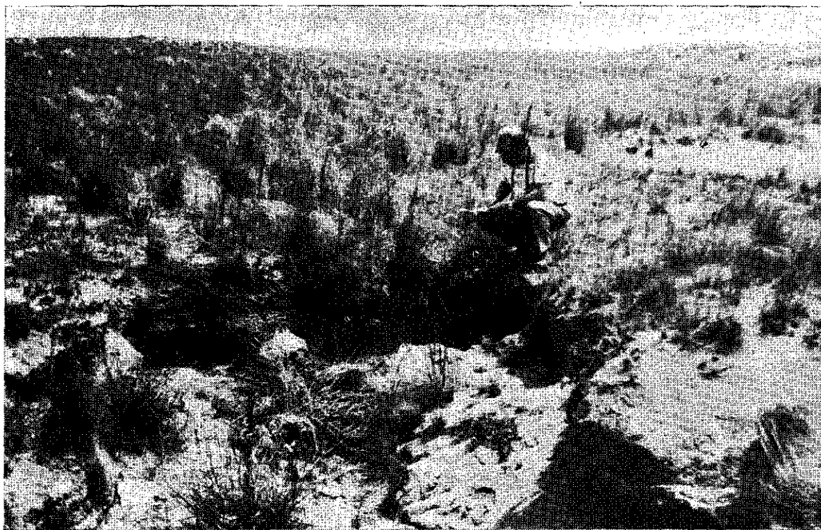
Foto 33 — Frente de ataque da erosão pluvial produzida no solo arenoso pela erosão remontante torrencial e surgida a partir de uma valeta localizada junto à rodovia.
