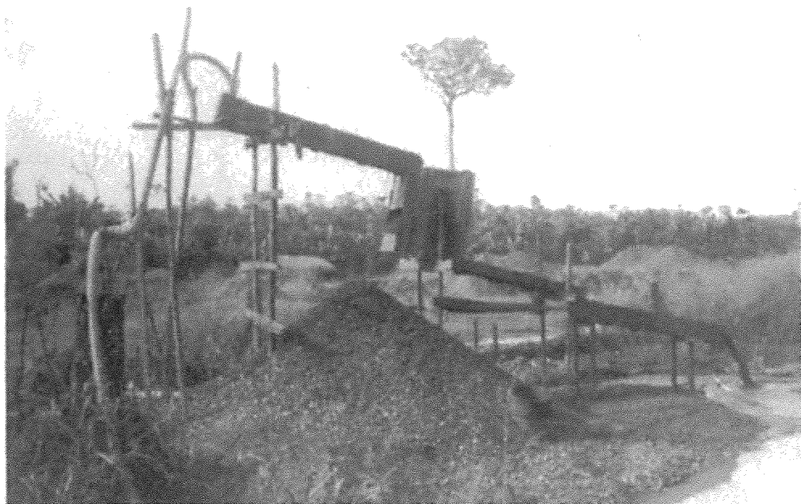
Foto 7 — Beneficiamento do cascalho no garimpo da Grota da Horta, vendo-se a mangueira vinda da chupadeira e que leva o cascalho até a caixa. Observar a adaptação feita pelo dono do garimpo para retirada das pedras.
