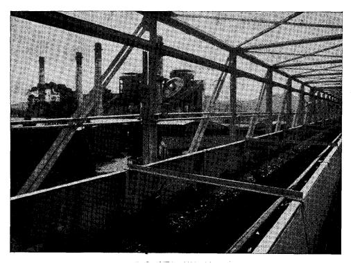
FOTO 6 — Detalhe do carregamento de carvão vapor para alimentar as fornalhas da Usina Jorge Lacerda. (Fotografia gentileza de Centrais Elétricas de Santa Catarina — CELESC)
