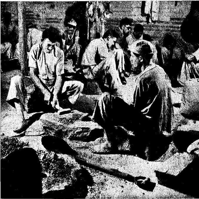
Moagem manual de minério de tungstênio para o enriquecimento por lavagem, no Nordeste. Fot. ALAN FISHER, Coordenador de assuntos Inter-Americanos — Reproduzida de Mineração e Metalurgia
