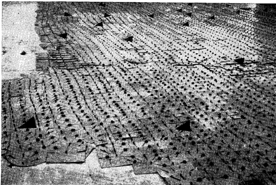
Fig. 1 — Aspecto da maior triangulação radial já executada no Brasil. Foi realizada pela LASA no Nordeste e compreendeu 4 682 fotografias aéreas, abrangendo uma área de 33 m 2 na escala de 1:50 000.
