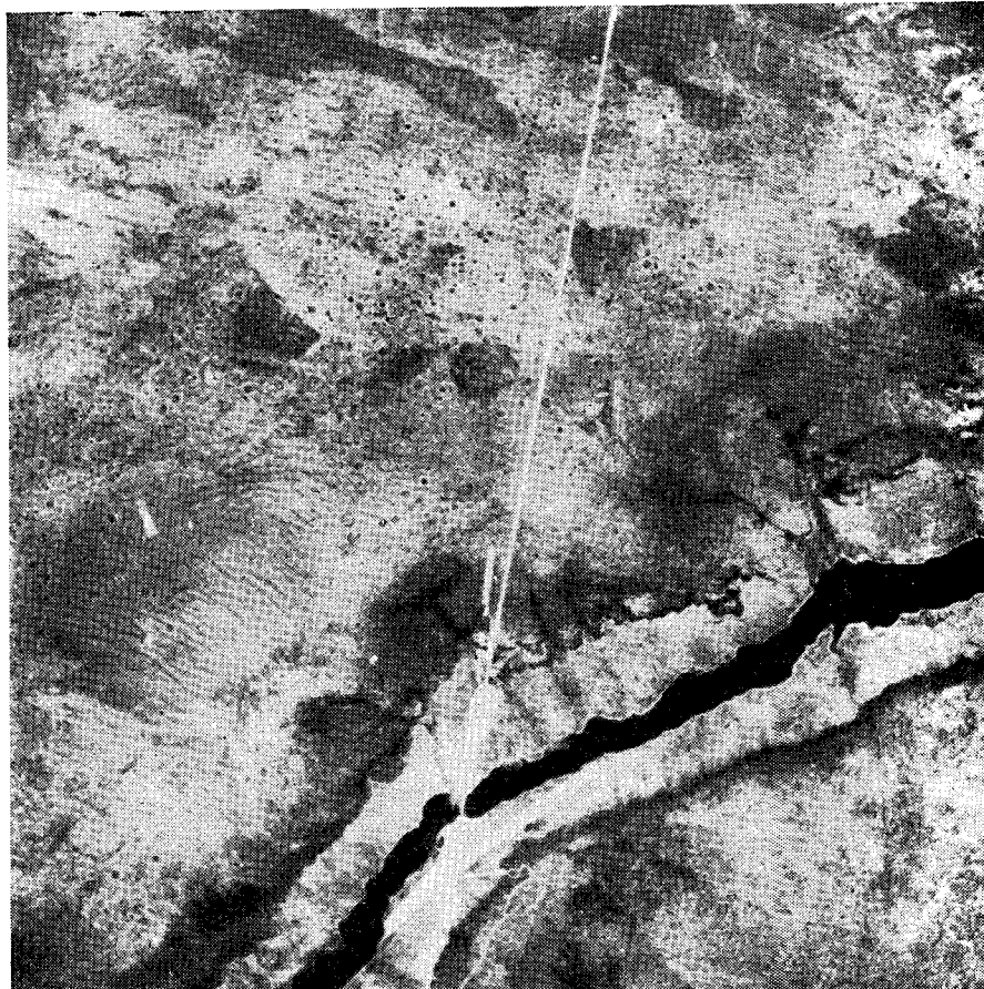
Fig. 23 — Trecho da estrada de rodagem Brasília-Fortaleza, em construção, cortando chapadões areníticos. Na fotografia vê-se um campo de aviação junto à ponte em construção sobre o rio das Fêmeas.
