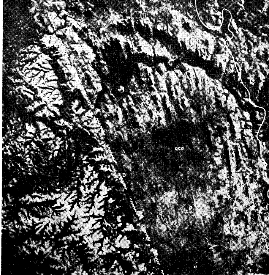
Fig. 16 — Contato de falha de gravidade entre quartzitos calcijeros e ardósias na região do rio do Inferno, no estado de Goiás. A morfologia das unidades distingue-se inconfundivelmente.
