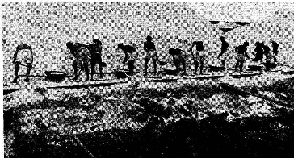
Foto 5 — Trabalho de transporte do sal do "atêro" para as barcas, à margem do rio Açú. O processo é rústico, empregam o "calão" — cesto de cipó — transportado por dois operários. (Foto do INS).
