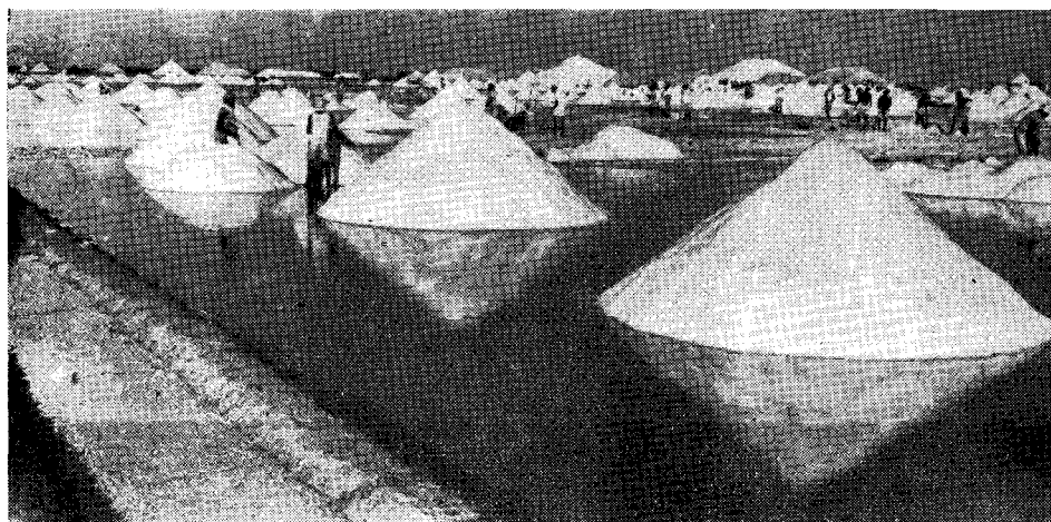
Foto 2 — Retirada do sal dos "baldes". A laje formada pelo sal é quebrada e os cristais desagregados, lavados e empilhados. No primeiro plano observa-se o sal amontoado nos "baldes", pronto a ser transportado para os "aterros" e, no segundo plano, vê-se, ainda, o trabalho de desagregação. (Foto do INS).
